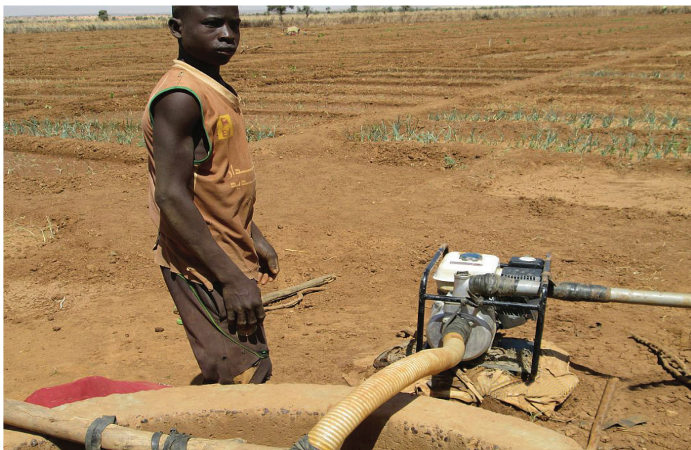
Motopompe utilisée en petite irrigation pour des superficies supérieures ou égales à 0,25 ha
